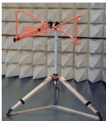
CBL 6143A horizontal onto tripod BTP 6020A
